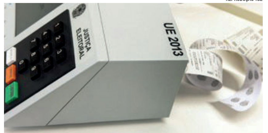
Boletins de urna são emitidos pela urna eletrônica ao final da votação
