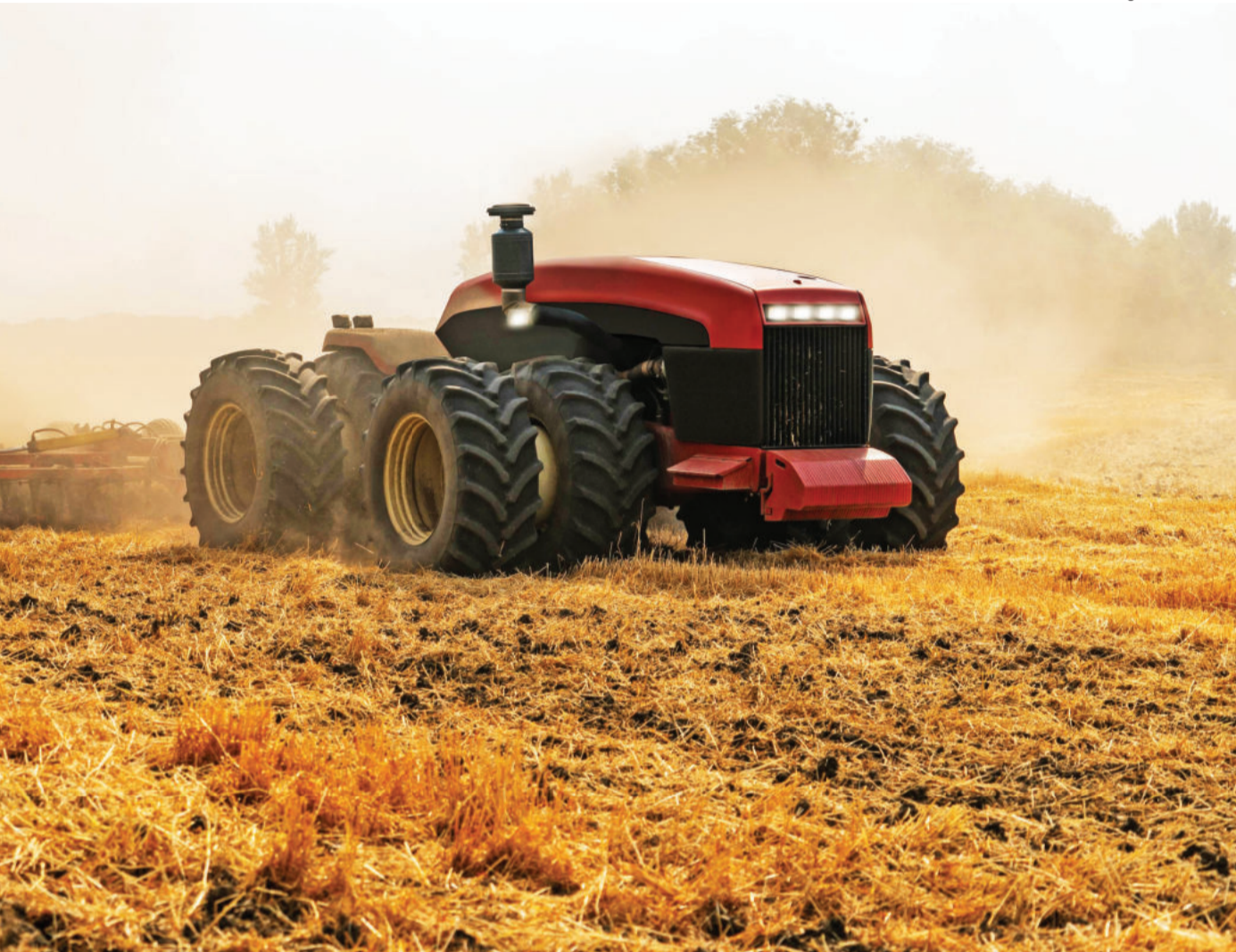
Conceito de máquina agrícola autônoma que dispensa o motorista e é conduzido remotamente.
