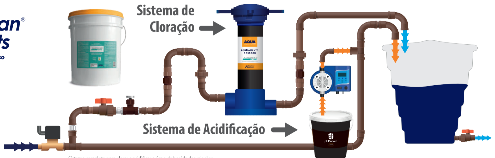
Sistema completo para clorar e acidificar a água de bebida das criações.
