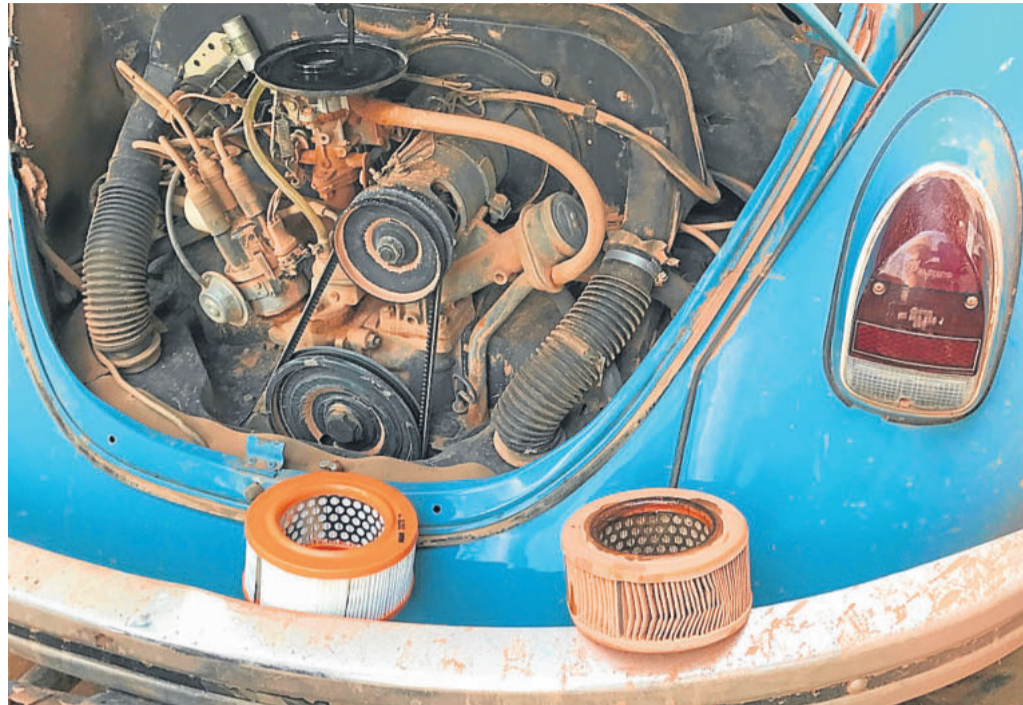
A diferença do filtro de ar usado e sujo para o filtro novo bem limpinho
