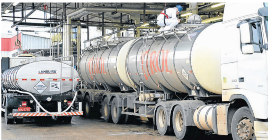
Carretas com capacidade de transportar até 33 mil litros de leite trazem matéria-prima dos entrepostos da Tirol localizados nos municípios de Tapejara e Boa Vista do Buricá
