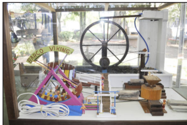
Na maquete, a roda d’água movimenta serraria, moinho, rotor de parque e o barco Viking
