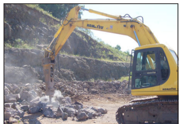
Rompedor é capaz de quebrar pedras em tamanho menor, para serem moídas no britador
