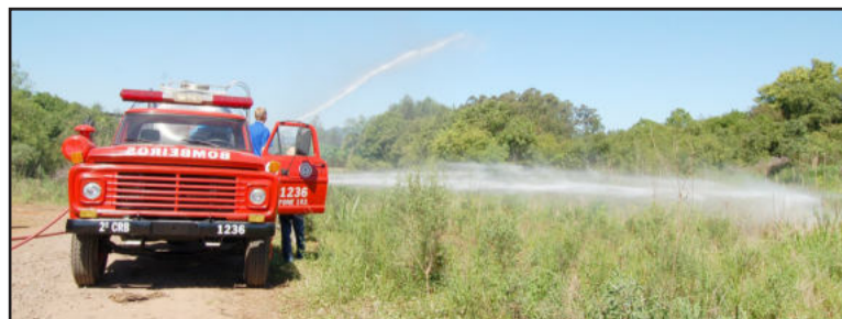
Bomba é capaz de abastecer duas mangueiras ao mesmo tempo com a mesma pressão
