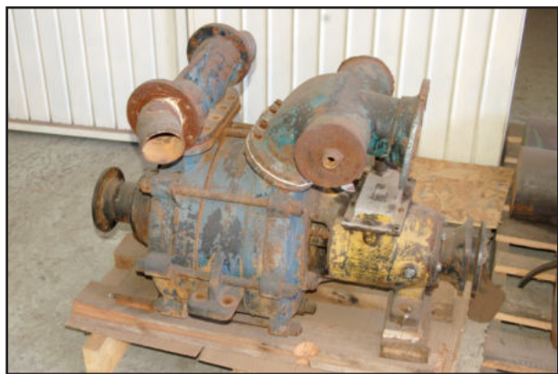
Antiga bomba foi substituída por uma muito menor, mais eficiente e totalmente asséptica
